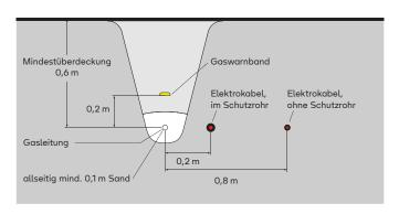
Vermaßter Querschnitt einer erdverlegten Leitung
